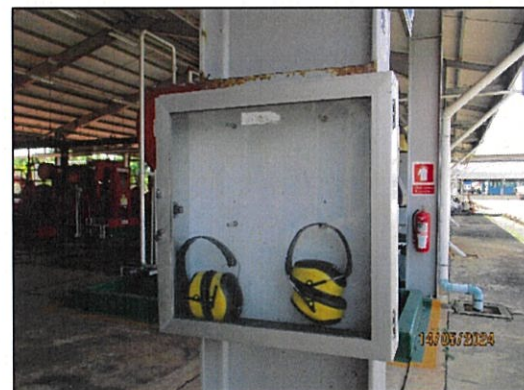
ภาพถ่ายที่ 2.2-4 ป้ายเตือนให้สวมใส่อุปกรณ์ป้องกันเสียง และการจัดเตรียมอุปกรณ์ป้องกันเสียงส่วนบุคคล สำหรับพื้นที่ปฏิบัติงาน
