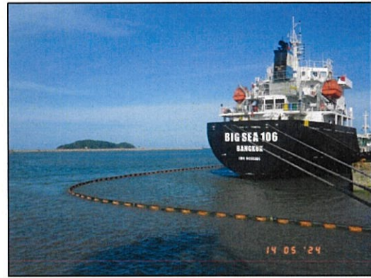
ภาพถ่ายที่ 2.2-2 การติดตั้งอุปกรณ์ป้องกันการรั่วไหล น้ำมัน ขณะมีกิจกรรมการขนถ่าย
