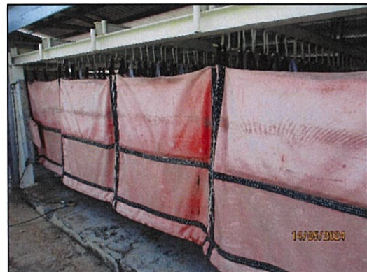
ภาพถ่ายที่ 2.2-3 การจัดเตรียมอุปกรณ์ขจัดครบน้ำมัน บริเวณท่าเทียบเรือของโครงการ
